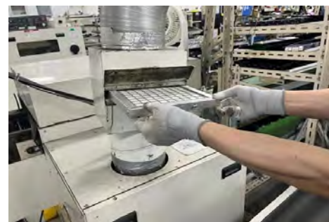
フィルター交換作業の様子
