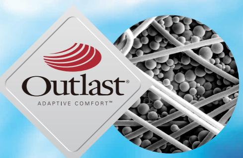
マイクロカプセルの働きで熱を吸収
