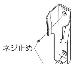
付属のネジ 2 本で、リモコンホルダーを固定する。
