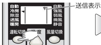
\* 運転切換ボタンを1回押すと、運転切換だけの表示になり、「冷房」に切り換わります。
