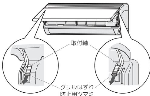
ツマミは止まるところまで引いて、確実にロックを解除してください。ロックが確実に解除されないまま吸込グリルをはずそうとすると、吸込グリルの取付軸が破損することがあります。
