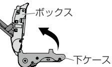
下ケース両端のガイドの間にエアフィルターの「オモテ面」を上にして、差し込む。
