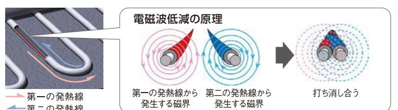
1本のコードの中に、電流の向きの違う2本の発熱線を通しました。互いに電磁波を打ち消しあい、その発生を大幅に抑えます。
